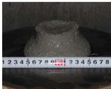
写真-2 フロー試験の状況
