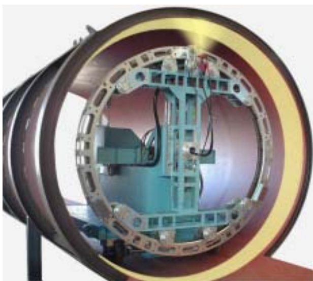
写真-1 スプレー状況
