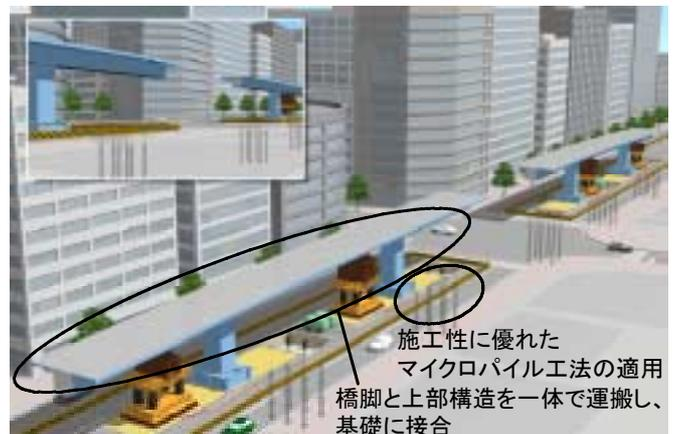
図-1 交差点立体化工法の例<sup>1)</sup>
