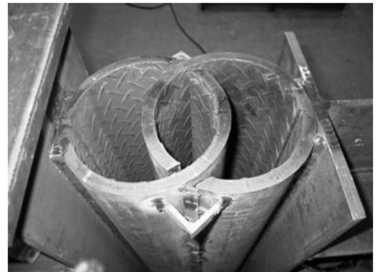
図1 縞鋼管継手
