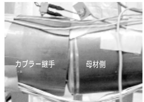
図5 継手近傍破断状況(B-3)
