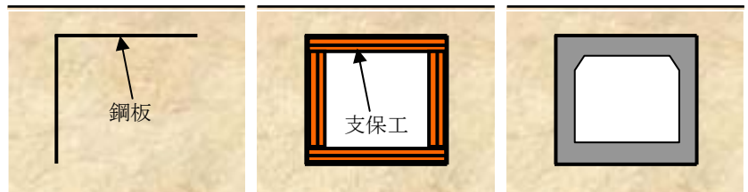
①地盤内に鋼板挿入
