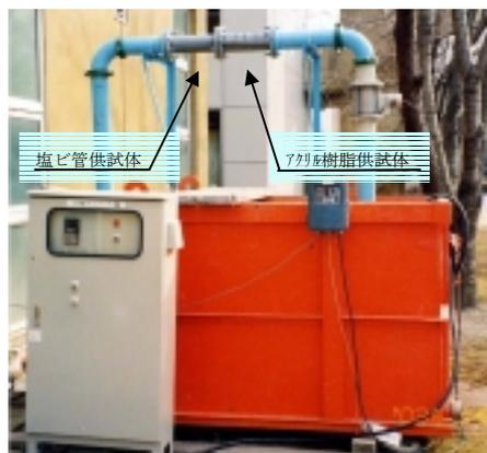
写真-2 砂粒輸送試験装置
