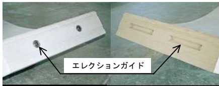
写真－１ 突合せ継手概要図
