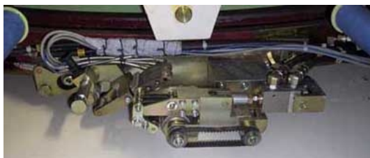
写真-2 円周方向溶着機
