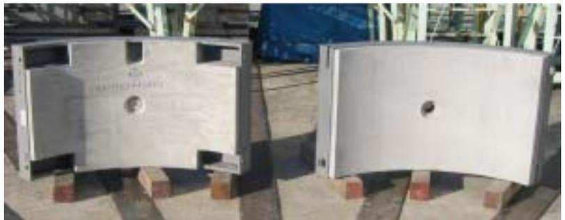
図-1 研究対象のコンクリート中詰め鋼製セグメント（左）
