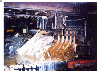
図 4 拡幅テールブラシ写真
