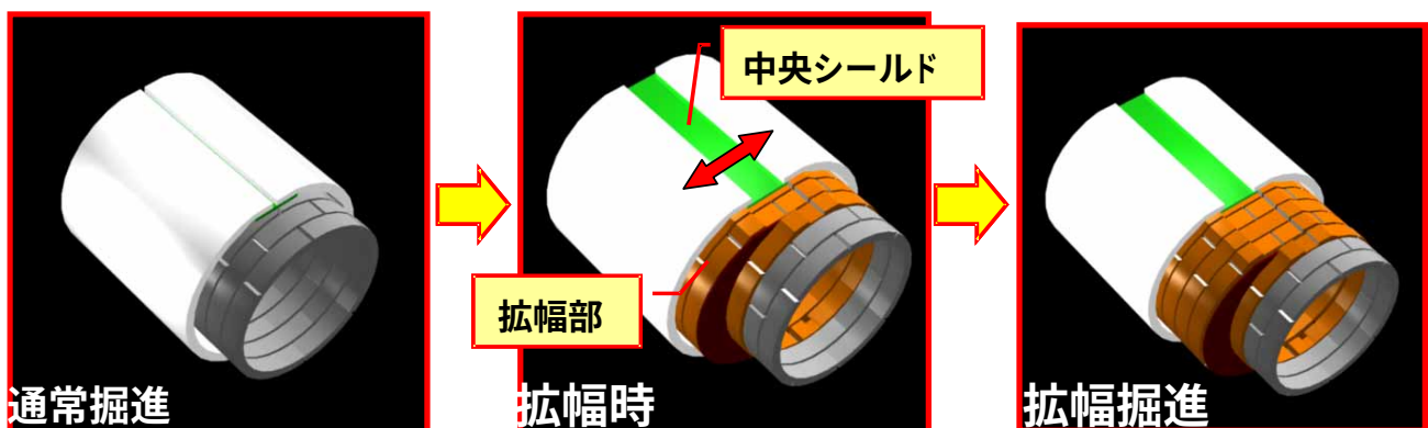
図1 VASARA-S工法概略図
