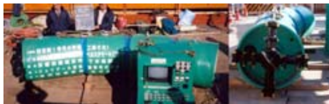
図 5 泥濃式推進工法の掘進機の概要
