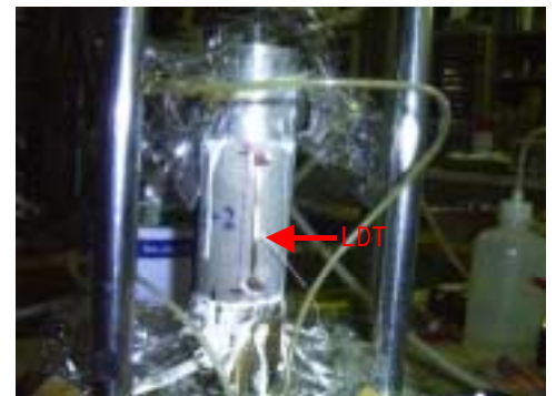
写真 1 LDT設置状況
