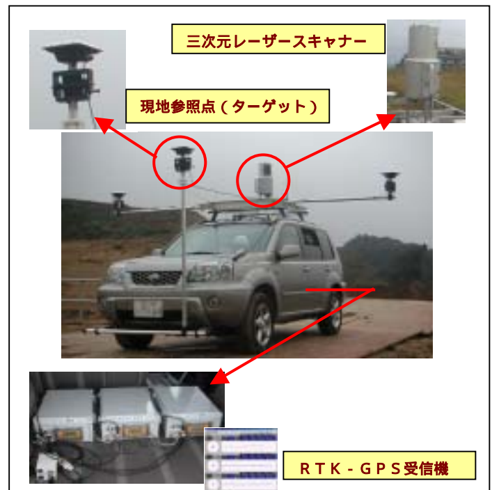
図—1 現地計測車両の機器構成
