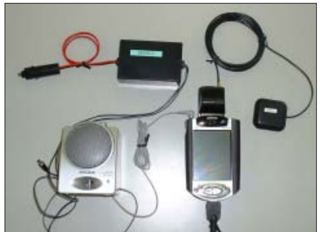
写真 - 1 ダンプ運行管理システム一式
