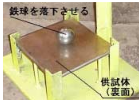
写真－1 ビアリット試験機
