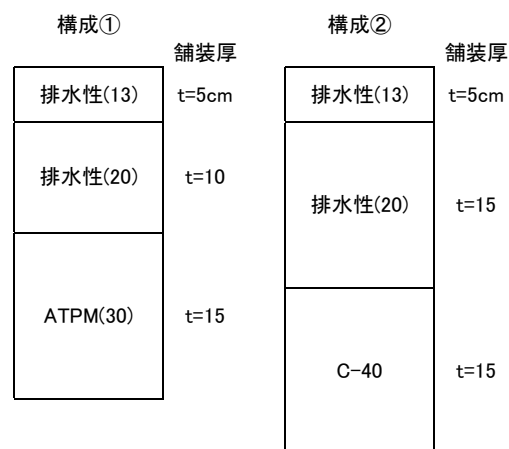
図-1. 検討した透水性舗装構成
