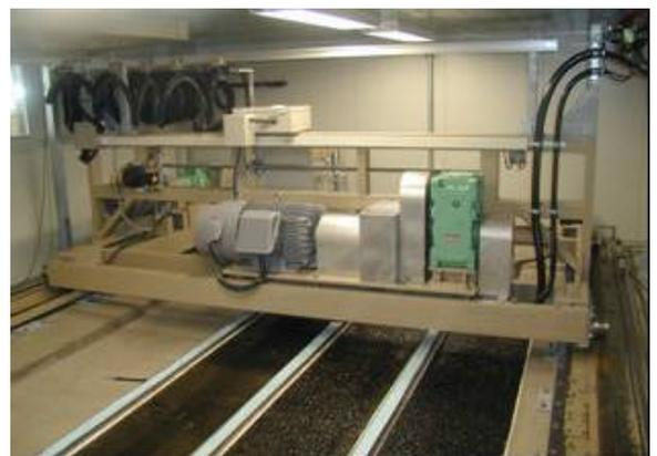
写真1 室内凍結路面走行試験装置
