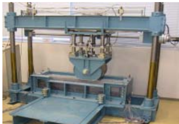
写真1 移動載荷試験の様子
