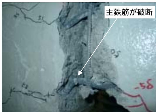
図 - 3 供試体の破壊性状の例
