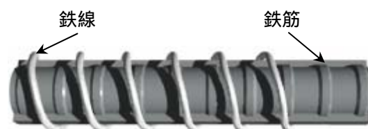
図-1 鉄筋スパイラル構造図
