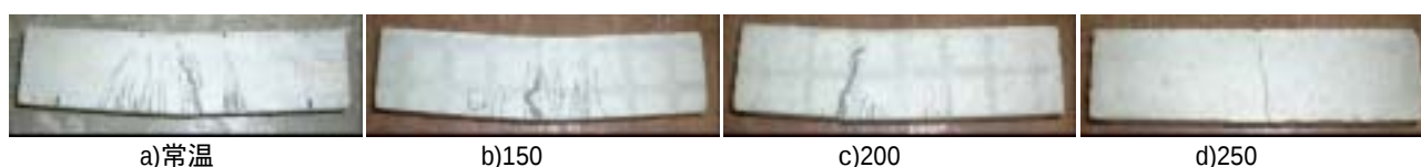
写真1 供試体の破壊状況
