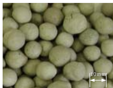
写真2 凍結融解100サイクル後の 10~15mmHLA2 骨材
