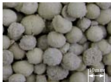
写真1 凍結融解100サイクル後の 10~15mmHLA1 骨材
