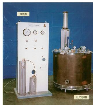
写真-1 高圧スランプフロー試験装置
