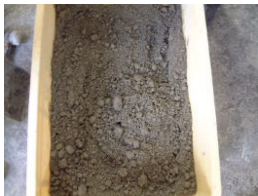
写真 - 3 締固め前のスラッジ
