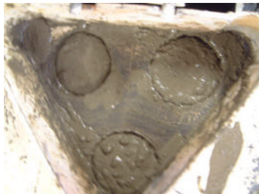
写真 - 4 締固め途中のスラッジ
