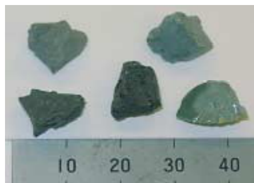
写真-1 廃プラ製粗骨材(5~10mm)
