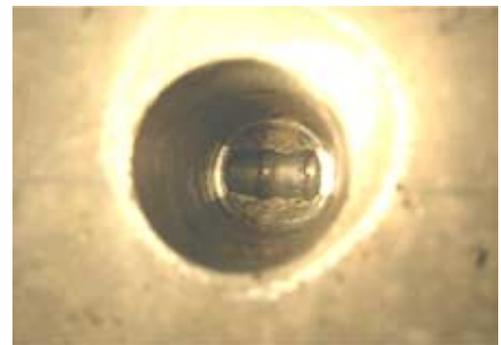
図-1 鉄筋部のコア抜き状況
