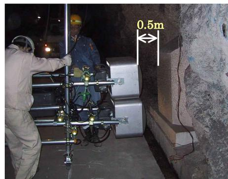
写真1 強制加熱状況(加熱距離 0.5m)
