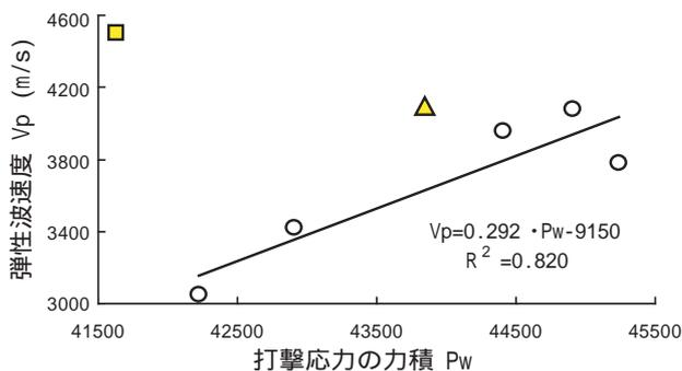
図-2 弾性波速度と打撃波形の力積
