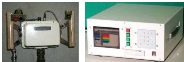
写真-1 探査装置（左：探査子、右：本体機）
