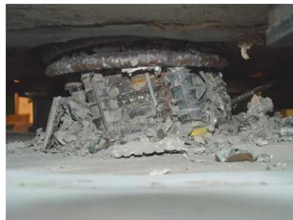
写真-1 60mm 荷重時の損傷状況 (S-16)
