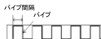
図-4 プレキャスト板内部パイプレイアウト
