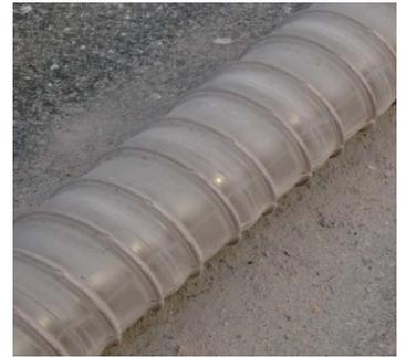
写真-3 グラウト試験体
