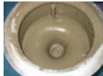
写真-2 グラウト練り混ぜ状況
