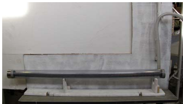
写真-1 充填性試験装置
