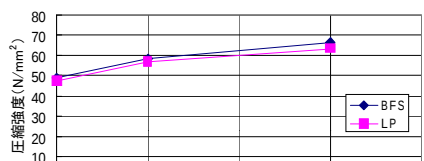
図-6 養生温度と圧縮強度（材齢4週）の関係
