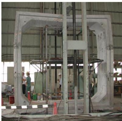
写真 - 1 最終破壊状況
