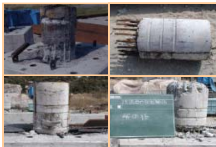
写真1 交番載荷試験後の供試体内部 (左上:実験1, 右上:実験2, 左下:実験3, 右下:実験4)
