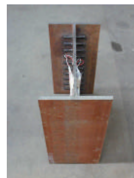
写真-1 試験体（内リブH形鋼）
