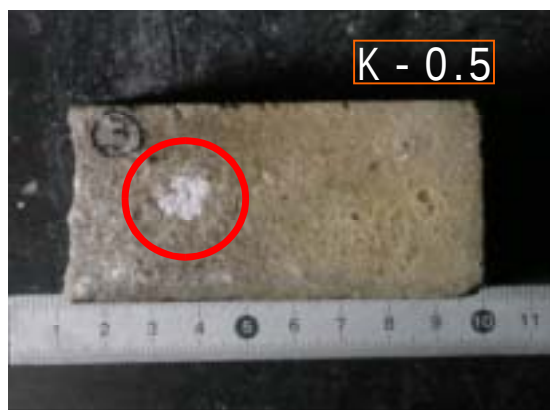
写真-1 モルタルの破壊状況
