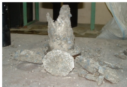
写真 2 再生 PET 樹脂ペレット（直径約 3mm）混入 コンクリート破断状況
