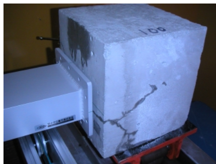
写真4 クラックに沿って水分が浸出した例
