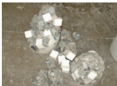
写真 1. 20mm角 PET 樹脂混入 コンクリート破断状況
