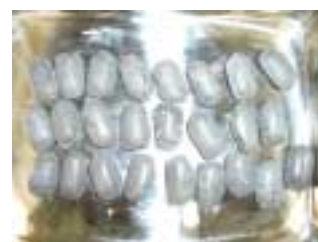
写真-2 試験後の固化物外観
