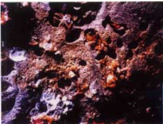
写真－２ NAクリート表面に穿孔するイワマテ貝
