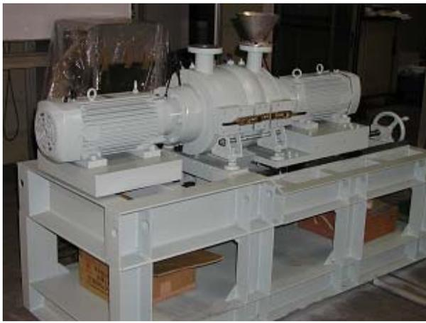
写真-1 破碎分級装置
