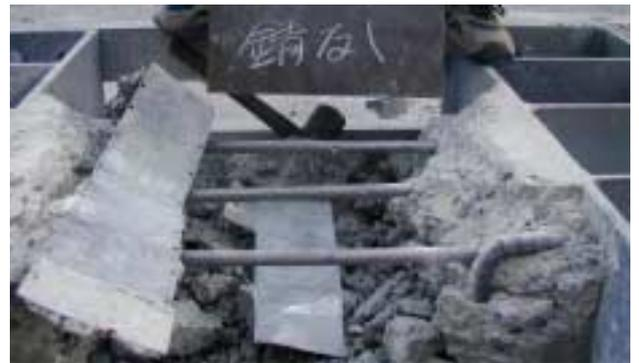
写真-3 止水板を配置した試験体の鉄筋 (錆の発生なし)
