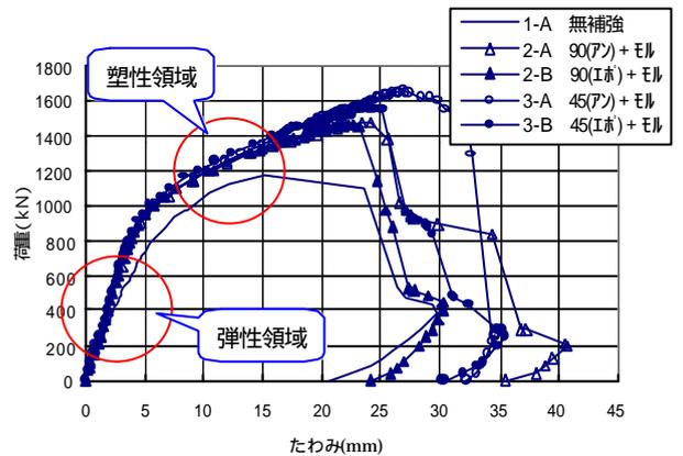
図 4 CFRP 格子配置角度と固定方法
