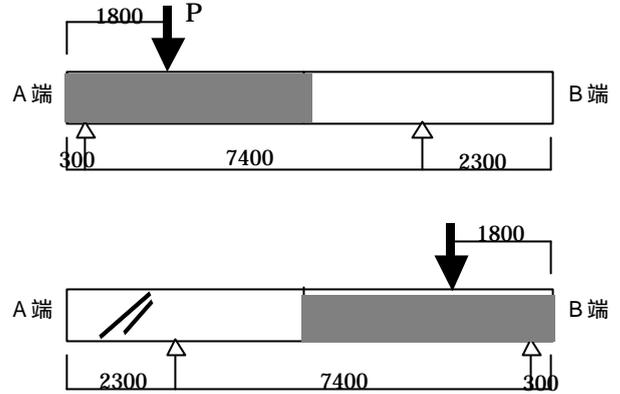
図 2 A, B 端の載荷手順
