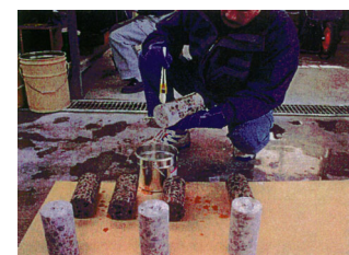
写真 - 3 コーティング剤塗布状況
