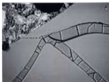
写真1 Gガラス粒子内部のASRゲル
