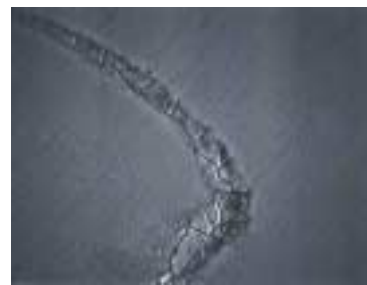
写真2 Fガラス粒子内部のASRゲル
