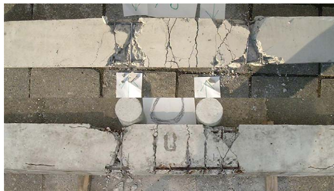
図-3 荷重後の供試体の例 (上: 鉄筋腐食のほとんどなかったもの, 下: 鉄筋腐食が進行していたもの)
