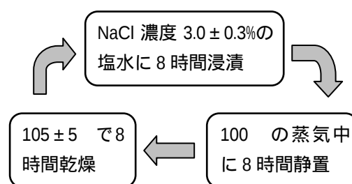
図-2 塩分浸漬乾湿繰返し促進試験方法
